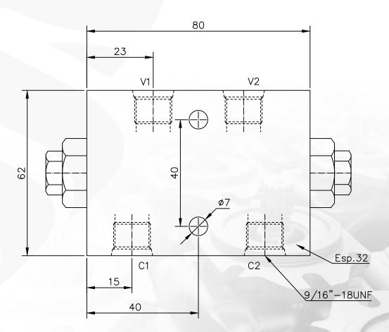
C1 e C2 devem ser ligados nos pórticos do cilindro V1 e V2 devem ser ligados nos pórticos do comando/válvula
